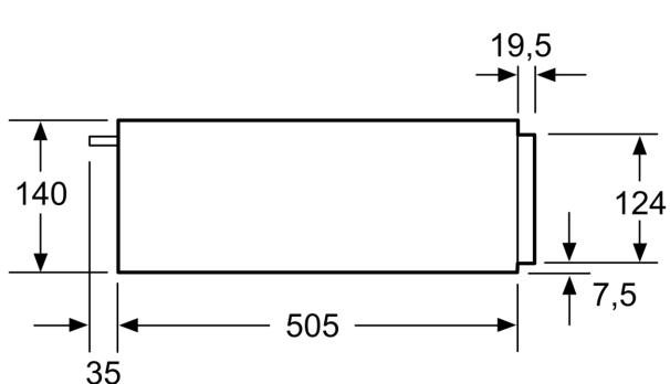
Il est possible d'installer des fours compacts d'une hauteur de 455 mm sur un tiroir chauffant.
