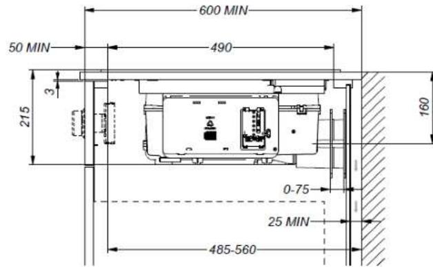
\* En cas d'installation directe contre un mur extérieur non isolé, nous recommandons l'utilisation d'un kit d'installation avec sortie d'air dans la plinthe.
