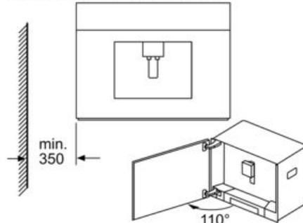
En cas d'utilisation de la limitation de charnière à 92° (réf. pièce détachée 00636455), la distance minimale au mur est uniquement de 100 mm. Mesures en mm
